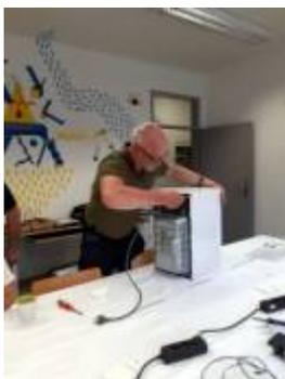
Nicht mehr einschalten lässt sich der Subwoofer „Canton SUB 650“. Hier fanden wir im Standby-Netzteil eine defekte [Schottky-Diode](#), die wir wechseln konnten. Nun geht er wieder.
