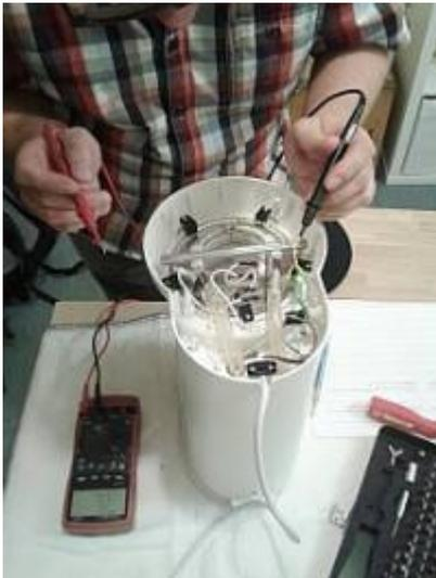
Offenbar in den Winterschlaf verabschiedet hatte sich eine AEG „CM2060A“ Kaffeemaschine, denn sie blieb gänzlich kalt. Mit dem Durchgangsprüfer testeten wir alle Verbindungsleitungen und maßen den Widerstand von Thermosicherung und Durchlauferhitzer. Bei Letzterem stellten wir leider fest, dass er durchgebrannt war. Da ein Ersatz-Heizelement nicht aufzutreiben ist, lässt sich das Gerät auch nicht wieder zum Leben erwecken und wird wohl seine letzte Reise zum Schrottplatz antreten müssen.
