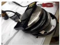
Zeitaufwendig aber mit guten Erfolgsaussichten war die Reparatur eines Staubsaugers "Dyson V11". Er ließ sich nicht mehr einschalten und alle Hinweise im Internet führten zu einem Kunststoffsteg am
