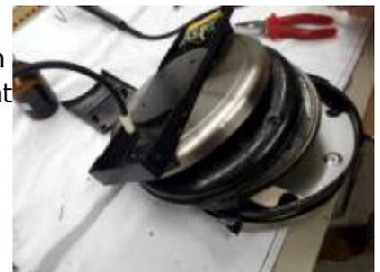
Zeitaufwendig aber mit guten Erfolgsaussichten war die Reparatur eines Staubsaugers „Dyson V11“. Er ließ sich nicht mehr einschalten und alle Hinweise im Internet führten zu einem Kunststoffsteg am
