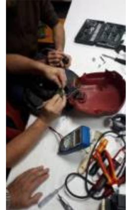
Ein Werkstattsauger „TH-VC 1930SA“ hatte so seine Probleme, wir stellen einen Schaden am Schalter und am Motor fest. Leider hätten da nur neue Teile geholfen. Die Ersatzteilpreise sind aber höher als ein neues Gerät. Schade.
