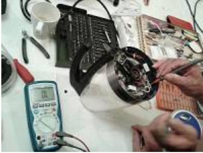
Ein Unold Wasserkocher blieb kalt und wurde daher zu uns gebracht. Nach einer eingehenden Prüfung von Zuleitung, Verdrahtung, Schalter und Heizelement konnten wir nur noch den Defekt des Heizers feststellen - ein irreparabler Schaden, mit dem leider das gesamte Gerät auf den Schrott wandern muss.
