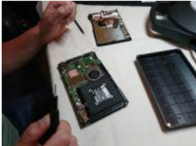
Der erste Besucher hatte eine Spielkonsole „Nintendo Switch“ mit, bei der die USB-C-Buchse mechanisch defekt war. Eine etwas knifflige Angelegenheit, zu der wir extra 2 Heißluftlötstationen bereitgestellt hatten. Nach dem Austausch funktionierte das Gerät aber leider nicht so wie erwartet, sodass die Reparatur das nächste Mal fortgesetzt werden muss.
