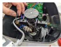
Der Staubsauger "FAKIR BlueLine" zeigte keinerlei Funktion mehr. Wir haben den Staubsauger demontiert und als erstens die Netzleitung und den Einschalter auf Durchgang geprüft. Alles i. O., Leitung und Schalter hatten Durchgang. Als nächstes löteten wir die Kondensatoren auf der Steuerplatine aus und überprüften sie. Ein Elko (100µF, 25V) hatte gar keine Kapazität mehr. Wir haben diesen Kondensator ausgetauscht, danach funktioniert der Staubsauger wieder.
