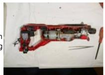
ist nun die Kühlung nicht mehr so effektiv wie vorher. Mit etwas weniger Beanspruchung kann die Säge weiter benutzt werden. Letztlich ist die Beschaffung eines Ersatzmotors in Erwägung zu ziehen. Dieser wird bei Einhell als Ersatzteil für 36 Euro angeboten. Der Gast wird sich das noch überlegen.
