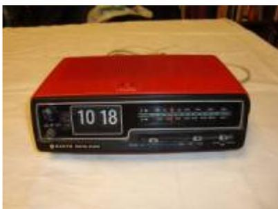
Ein elektromechanisches „Schmankerl“ war ein Radiowecker mit einer [Klappziffernanzeige](#) aus den 70er Jahren. Das Radioteil ging noch, aber das Uhrwerk nicht mehr. Wir bemerkten, dass der Motor, der das Uhrwerk über ein Getriebe antreiben sollte, sich nicht mehr drehte. Nach dem Ausbauen fluteten wir die gleitgelagerte Motorwelle mit Öl und nach einiger Einwirkzeit drehte er sich und trieb das Uhrwerk wieder an.
