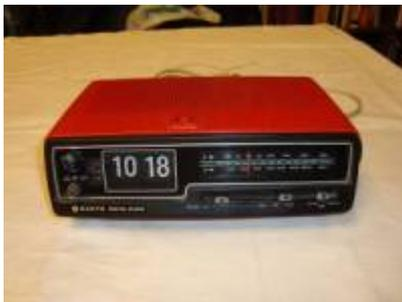
Ein elektromechanisches „Schmankerl“ war ein Radiowecker mit einer Klappziffernanzeige aus den 70er Jahren. Das Radioteil ging noch, aber das Uhrwerk nicht mehr. Wir bemerkten, dass der Motor, der das Uhrwerk über ein Getriebe antreiben sollte, sich nicht mehr drehte. Nach dem Ausbauen fluteten wir die gleitgelagerte Motorwelle mit Öl und nach einiger Einwirkzeit drehte er und trieb das Uhrwerk wieder an.
