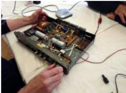
Los ging es mit der Fortsetzung der Reparatur des Verstärkers „RFT SV3930“ vom [RC in Gruna](#). Das Gerät hatte Tonaussetzer bzw. Schwankungen der Lautstärke. Als Ursache konnten wir das [Lautsprecherabschaltrelais](#) diagnostizieren, bei dem die Kontakte in den 35 Jahren korrodiert waren. Wir haben das Relais geöffnet, die Kontakte gereinigt und mit Kontaktspray behandelt. Wenn es wieder auftreten sollte, könnten wir das Relais auch ersetzen.
