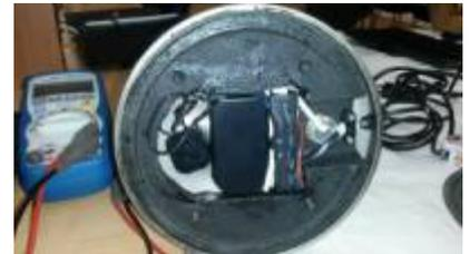
In einer Schreibtischleuchte konnten wir einen defekten Transformator feststellen. Ob ein Ersatzteil in passender Größe auffindbar ist, bleibt noch unsicher.
