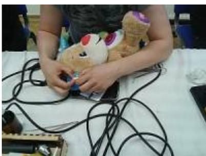
Eines fachkundigen „Ohrenarztes“ bedurfte ein Fisher Price „Lernspaß-Hündchen“ (CDL23), den ein anderer Gast dabei hatte. Dieses kleine Plüschtier verfügte über eingebaute LEDs und ein Sprachmodul, das mittels verschiedener Taster in Händen, Füßen, dem Bauch und den Ohren aktiviert werden konnte. Ein Drücken am rechten Ohr blieb seit Kurzem jedoch ohne Funktion. Hier hatte sich der Kontakt vom eingebauten Taster gelöst und musste nur neu angelötet werden. Dank tatkräftiger
