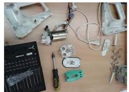
Im Lastbetrieb machte ein Braun „multimix Typ 4642“ Handrührgerät immer gleich schlapp und das Rührwerk stoppte abrupt. Der Besitzer zerlegte und untersuchte das Gerät eigenständig und entdeckte im Getriebe dann auch ein lockeres Zahnrad, dessen [Presspassung](#) ausgeleiert war und das sich deshalb von der Motorwelle zu lösen begann. Wir halfen ihm, es mit Zweikomponentenkleber wieder zu befestigen, und assistierten noch beim Zusammenbau. Wenn der Klebstoff vollständig
