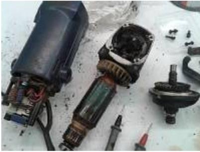
Ein Winkelschleifer lief im Betrieb nur noch äußerst ruckelig und begleitet von Bürstenfeuer sowie unter starker Rauch- und Geruchsentwicklung. Ein zunächst vermuteter Getriebeschaden oder abgenutzte [Kohlebürsten](#) bestätigten sich nicht. Dagegen offenbarte eine Widerstandsmessung am Rotorpaket einige defekte Spulenwicklungen - ein irreparabler Schaden, mit denen der Motor leider nur noch dem Schrott zugeführt werden kann.
