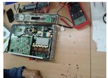
Ein Pioneer „VSX-S300-S“ Mehrkanal-Receiver ging nicht mehr an. Sein Besitzer vermutete, dass es sich vielleicht um eine durchgebrannte Sicherung im Inneren handeln könnte. Bei eingehender Begutachtung war diese aber ok und der Fehler stellte sich doch als etwas komplexer heraus als
