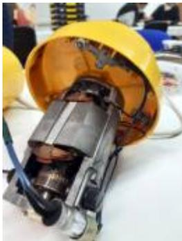
Ein anderer Gast brachte einen Lebensmittelzerkleinerer „Multiboy“ mit. Beim Einschalten des Gerätes fehlt die Kraftübertragung auf die Schneidmesser. Das Mitnahmestück hatte sich von der Motorwelle (Presspassung) gelöst. Ein Ersatzteil ist aktuell nicht verfügbar. Unser Gast will versuchen das Mitnahmestück in die Motorwelle einzukleben. Wir drücken Ihm die Daumen!
