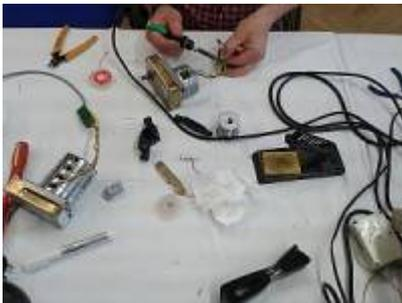
Weiterhin stand bei den beiden Getriebemotoren aus dem Antrieb seiner Pelletofenheizung, mit denen er [ebenfalls Ende April](#) zu Besuch war, ein Austausch der alten Motorkondensatoren an. Nachdem nun passende Ersatzteile beschafft waren, lötete er diese heute ein und testete die Motoren erfolgreich. Daheim wird er schließlich noch Schrumpfschlauch anbringen, den wir diesmal in Ermangelung einer richtigen Heißluftpistole nicht fest genug aufschumpfen konnten.
