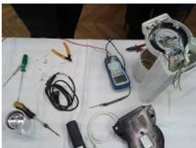
Ein simpler Kabelbruch in der Zuleitung war der Grund, warum eine Siemens „KA 12“ Filterkaffeemaschine nicht mehr ging. Da der Fehler unmittelbar an der Knickstelle am Gerät lag, konnten wir ihn durch Einkürzen und neu Anschließen des Zuleitungskabels ohne Weiteres beheben.
