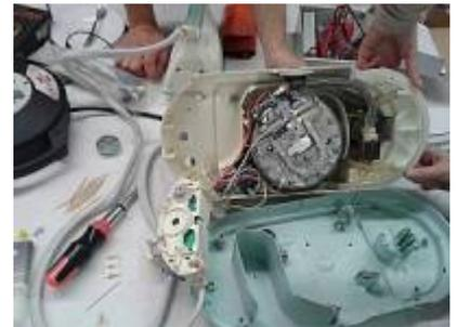
An einer Rowenta „Expert DG 920“ Dampfbügelstation war der Bedienschalter in das Gehäuse gedrückt und ließ sich so nur schlecht betätigen. Hier war ein Kunststoff-Haltedom im Inneren abgebrochen und wurde mit etwas Zweikomponentenklebstoff wieder angeklebt. Zusätzlich bastelten wir zur weiteren Stabilisierung einen behelfsmäßigen Anschlag hinter den Schalter.
