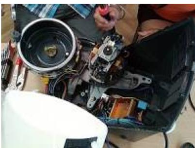
Für den Thermomix [vom RepairCafé Ende April im Rosenwerk](#) waren inzwischen die bestellten Ersatzteile eingetroffen, sodass die Besitzerin heute wiederkam und wir zusammen die Reparatur fortsetzen konnten. Das Antriebsritzel des Schneidwerkes wurde gewechselt und neue Lager wurden eingebaut. Der Test nach dem Zusammenbau enttäuschte dann allerdings, da sich der Motor nach wie vor nicht drehte und das Gerät durch beständiges Piepen lediglich einen Fehler signalisierte. Die
