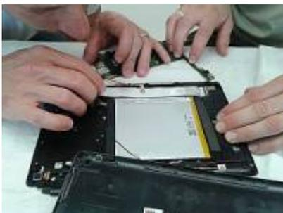
Gut vorbereitet erschien ein Gast, an dessen ASUS „Zenpad 10“ Tablet-PC die USB-Ladebuchse kaputtgegangen war. Er brachte bereits eine passende Ersatzbuchse mit, die er nach kurzer Anleitung mithilfe unserer Lötstation selbst einbaute.
