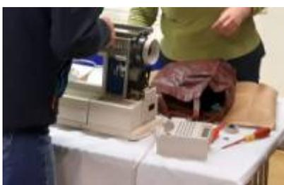
Bei der Nähmaschine „TEXTIMA famula 4690“ war die Bedienung blockiert. Die Maschine war intern mechanisch verstellt. Sie wurde wieder eingestellt und gereinigt.
