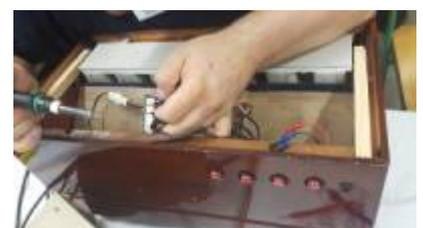
Weiterhin wurde ein Uhrenbeweger gebracht, der sich nicht mehr drehte. Die Drehzahlsteuerung
