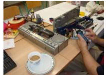
Bei einem Doppel-Kassetten-Radio funktionierte die Wiedergabe nicht mehr. Das lag zum einen an ausgeleiteten [Peesen](#) und zum anderen an einer gebrochenen Wiedergabe-Taste. Die Taste haben wir geklebt und die Peesen werden wir beim nächsten Mal einbauen, wenn der Besucher wiederkommt.
