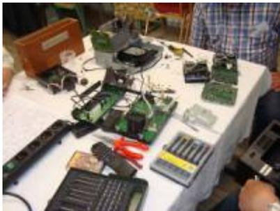
Ein Philips „FW 46/22“ HiFi-Turm wollte keine Kassetten mehr abspielen. Nach einem aufwändigen Auseinanderbauen zeigte sich der übliche Fehler, dass die Gummiriemen nach einigen Jahren an Spannung verloren und eine andere Konsistenz angenommen hatten. Leider passte keiner unserer vorrätigen Riemen, sodass die Besitzerin bis zum nächsten Mal Neue besorgen muss. Dann können wir daran weiterarbeiten.
