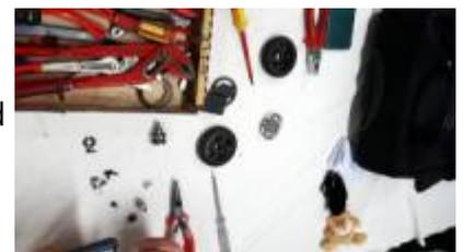
Eine ganze Weile versuchten wir eine rollbare Reisetasche „Kipling“ zu reparieren und wogen die verschiedenen Möglichkeiten ab. Hier war das Rad auf einer Seite abgefallen, das Kugellager hatte sich aufgelöst und auch das Rad der anderen Seite wackelt schon verdächtig. Wir entfernten beide Achsstümpfe und versuchten Ersatzteile im Internet zu finden. Wir werden 2 neue Kugellager bestellen und aus Schrauben neue Achsen bauen. Fortsetzung folgt ...
